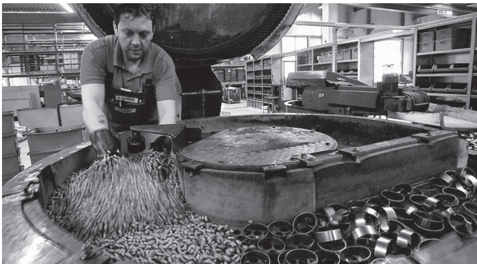
Saubere Sache: In einer großen Maschine werden die gefertigten Teile gereinigt.
